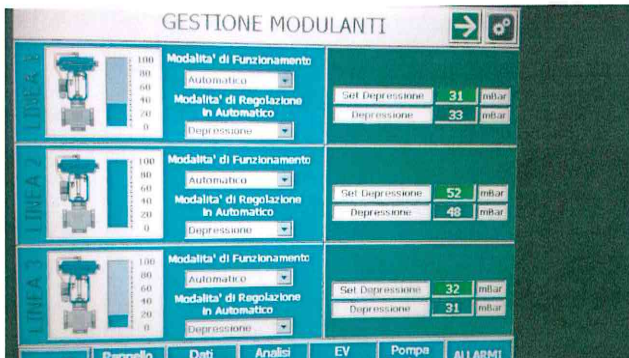
Figura 7 L'immagine evidenzia l'impostazione rilevata al momento del controllo in relazione al sistema di aspirazione del biogas.
