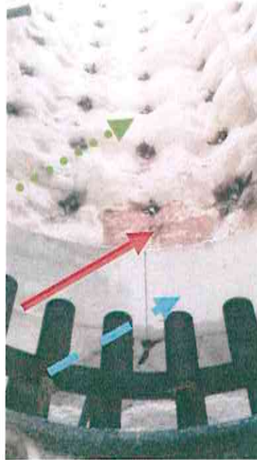
Figura 6 Interno della torcia, foto ritratta attraverso la serranda di regolazione dell'aria comburente posta alla base della torcia.
